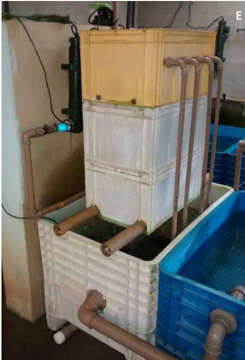
Figura 61. Filtro biológico: com mídias fluidizáveis compostas por recortes de conduítes com 30 mm (A); com mídias de nanoesferas em camadas semi-inundadas ou dry-wet (B); filtro rizosférico (C); detalhe da drenagem do filtro rizosférico para o tanque de abastecimento (D); filtro dry-wet (E); detalhe de compartimento com lâ filtrante no filtro dry-wet (F).
