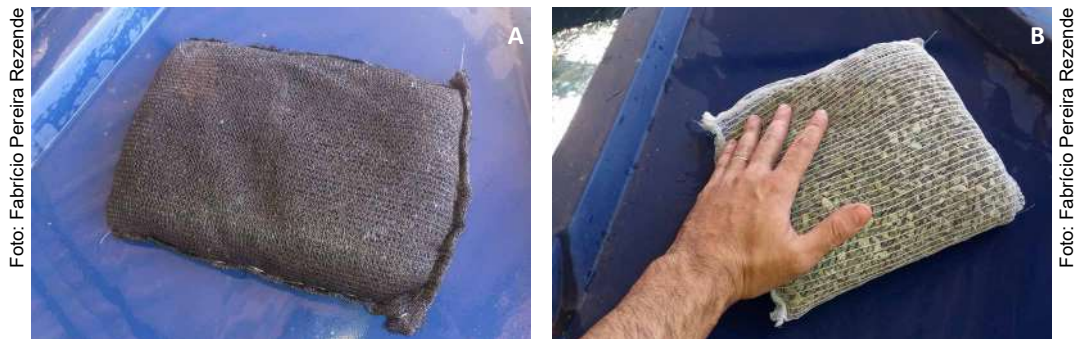
Figura 62. Filtro de adsorção: bolsa com carvão ativado (A); bolsa com zeólita ZN (B).
