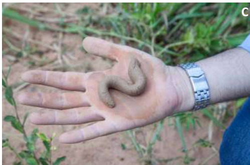
Figura 24. Teste rápido para avaliação da composição de solo para construção de viveiros escavados: solo com baixo teor de argila (A); solo com teor de argila adequado para viveiros aquícolas (B); solo com elevado teor de argila (C).
