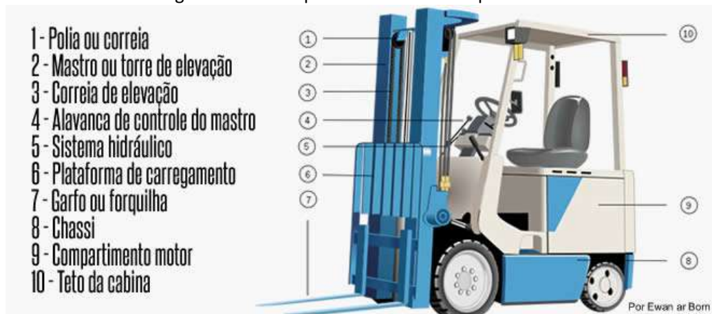
Figura 106 – Componentes de uma empilhadeira
