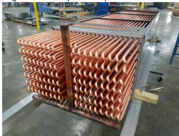
Figura 41 – Exemplo de evaporador de tubo liso
