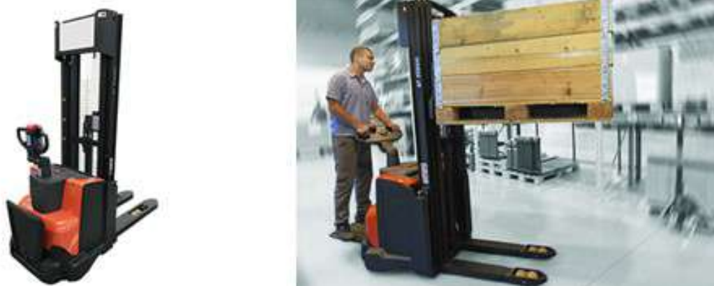
Figura 107 – Exemplos de empilhadeira elétrica
