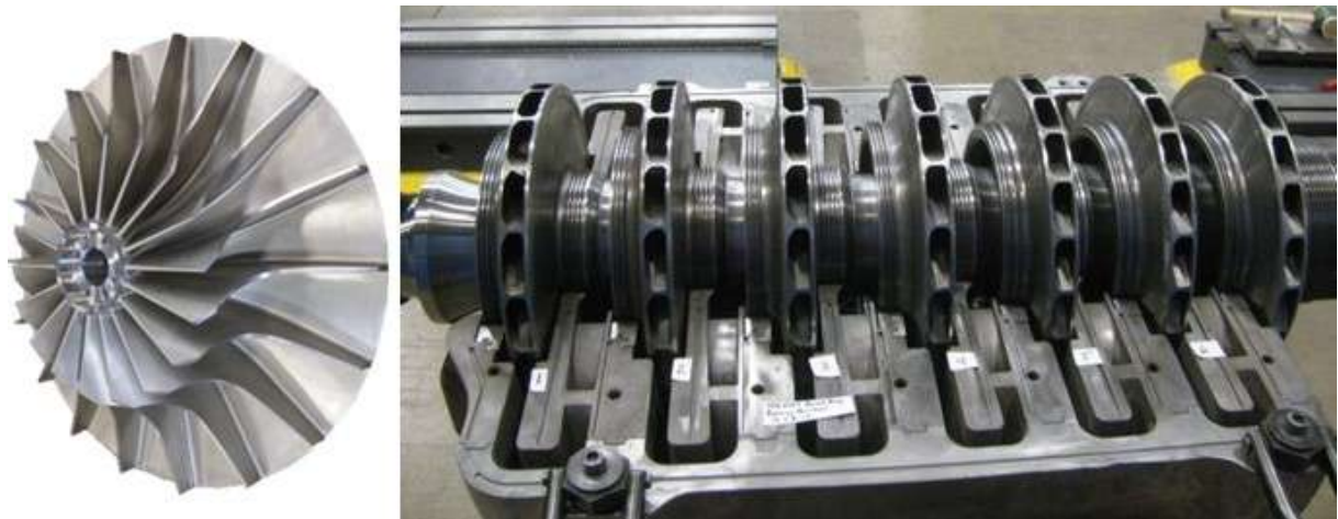
Figura 71 – Mecanismos interno do compressor de pás
