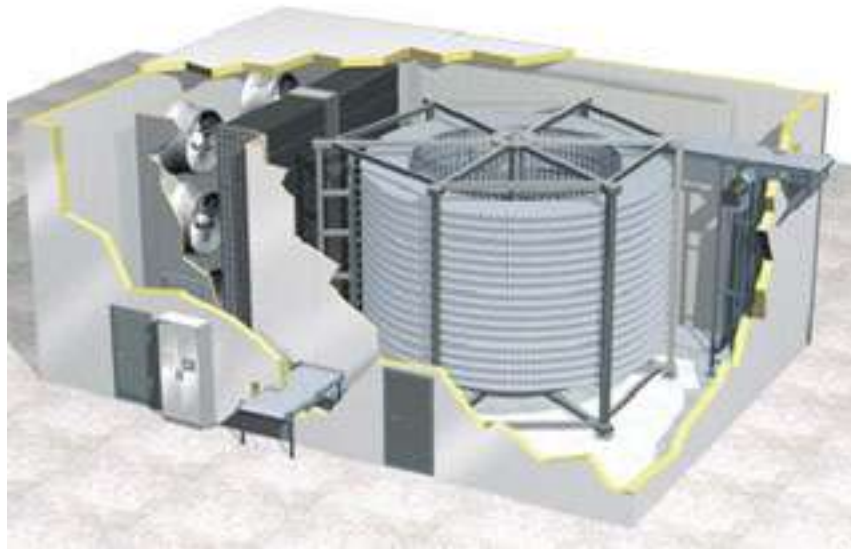
Figura 10 - Exemplo de túnel de congelamento em espiral que opera em processo contínuo
