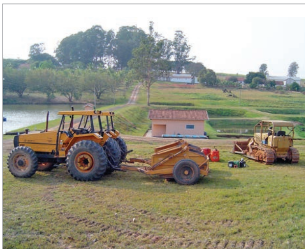
Figura 7. Máquinas utilizadas para a construção dos viveiros (Scraper e trator de esteira)
