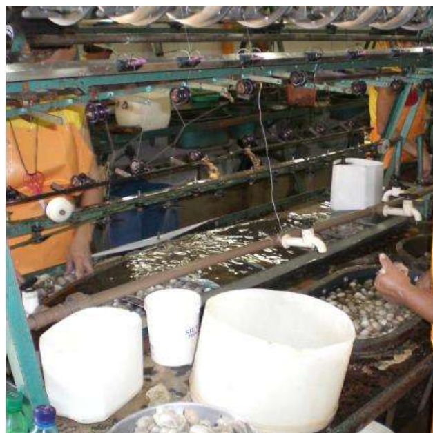
Figura 16 – Casulos imersos em água e escupinadeira
