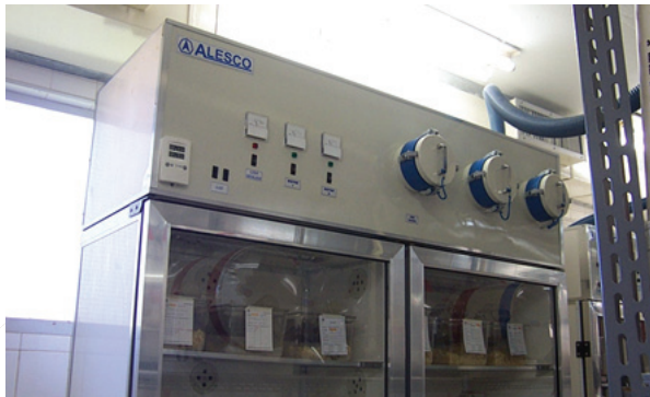
Figura 2. Tipo de estante ventilada e climatizada. Fonte: Marcel Frajblat,2003
