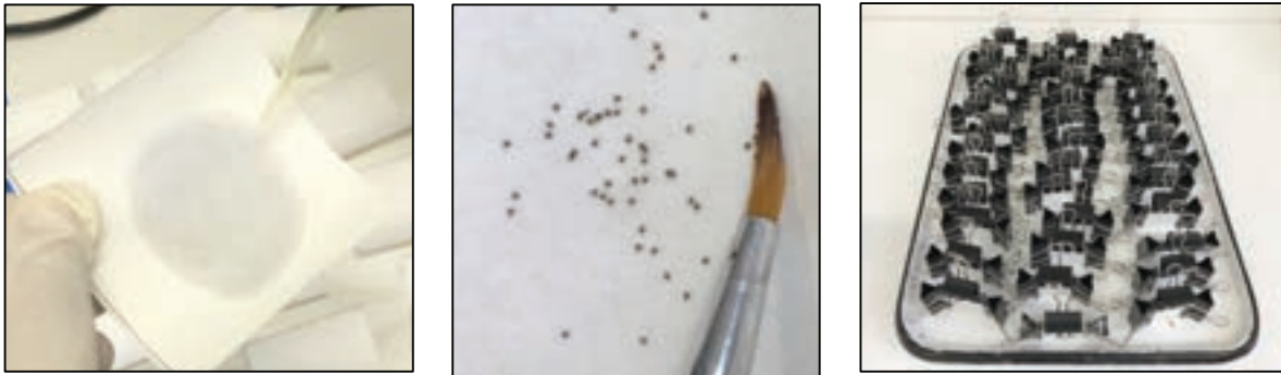
Figura 11. Teste do envelope de larvas (TEL). Sequencia do TEL para avaliação da toxicidade dos acaricidas contra larvas (da esquerda para a direita): impregnação de papel filtro; identificação e contagem de larvas antes do teste; envelopes com as larvas incubadas.
